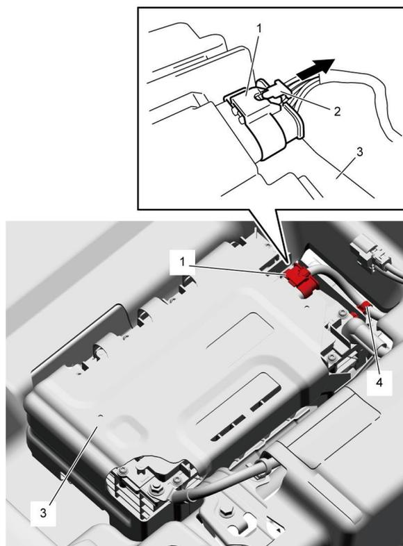
12) Retire la tuerca de la terminal "48 V+" (1) y la tuerca de la terminal "48 V-" (2), y luego retire los cables.
