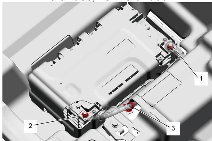
14) Retire los pernos del soporte de la batería de iones de litio (1) y, a continuación, retire el soporte de la batería de iones de litio (2) y la batería de iones de litio (3).
