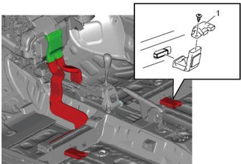
9) Odspojite stezaljku kabelskog svežnja (1).
