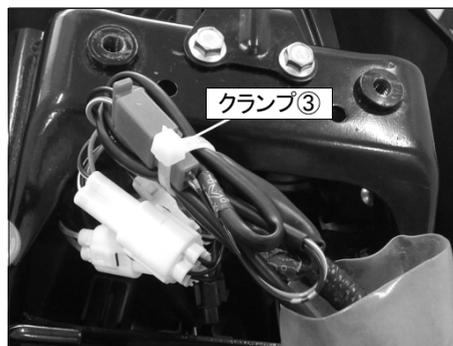
5. 配線類をブーツ内に格納し、リアキャリアプレート下に配置します。
