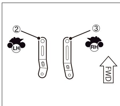
3. ボルト⑤とナット⑥を使用して、左側ステー②、右側ステー③およびマウントバー①を一時的に組み立てます。
