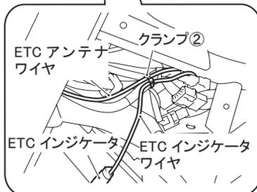
3. ETC アンテナワイヤと ETC インジケータワイヤを、メインハーネスに沿って配線し、クランプ②で固定します。
