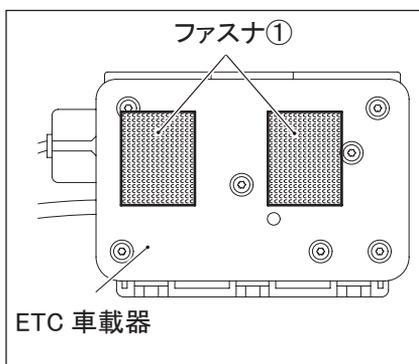
3. ETC 車載器の開口部を後方に向くように仮組みします。
