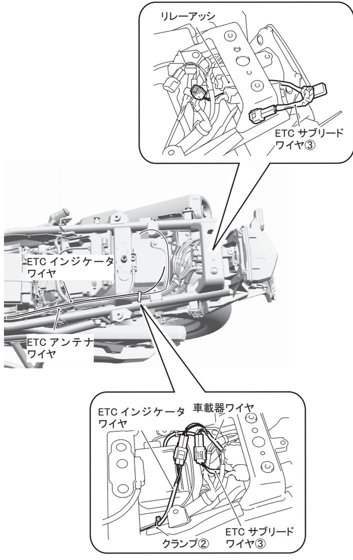
2. ETC アンテナワイヤと ETC 車載器ワイヤを結線します。
