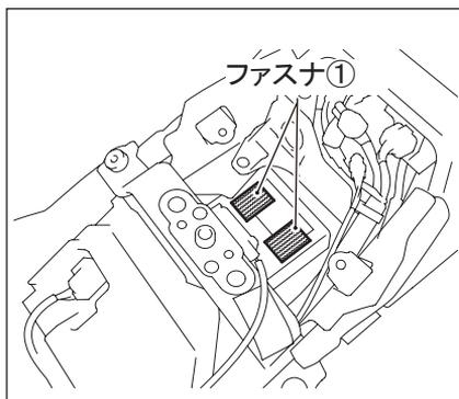
2. ETC 車載器裏面にファスナ①を貼付けます。
