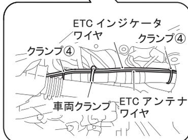
3. ETC アンテナワイヤと ETC インジケータワイヤをメインハーネスに沿わせて、クランプ④で固定します。
