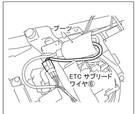
3. ETC アンテナワイヤを車載器に結線し、図の様に配線します。
