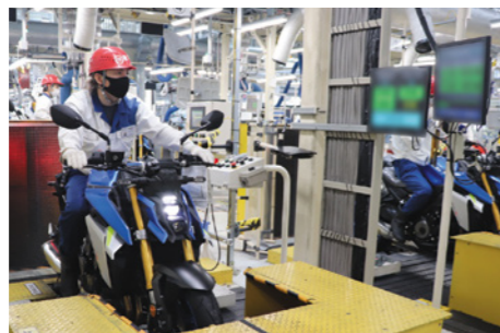
完成検査 Final Inspection
